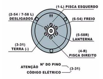
Esquema de ligação de acordo com a norma NBR 3732 de 2006.
