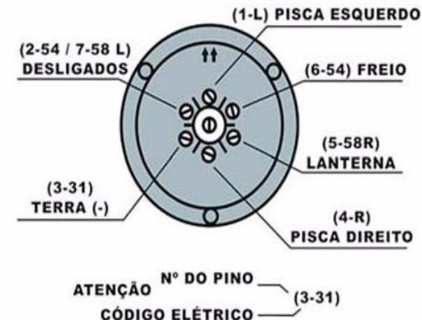
Esquema de ligação de acordo com a norma NBR 3732 de 2006.
